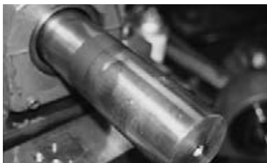
Cojinete de tornillo de sujeción después de 500 horas
