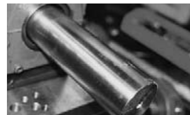
Cojinete IMPERIAL después de 2.500 horas
